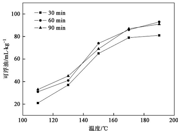
图3 不同加热时间下可浮油随温度变化
