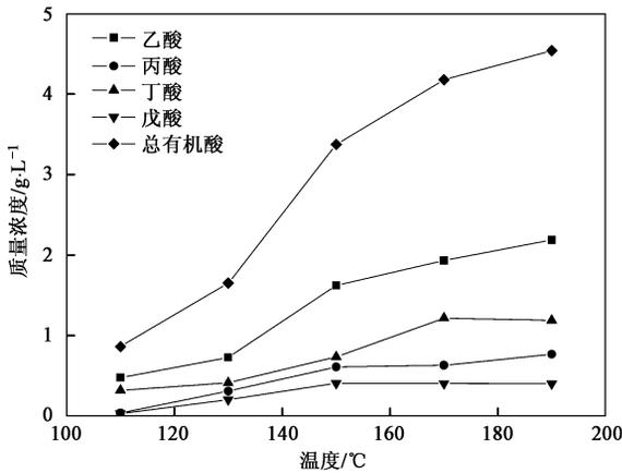
图2 水热产物有机酸浓度随温度变化
