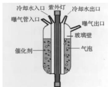
图1 光催化反应装置示意图
