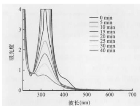
图 10  $\text{Ce}^{3+}$  对对硝基苯酚的光催化降解
