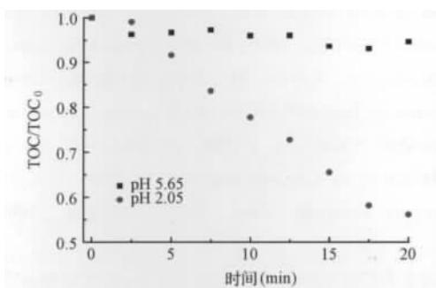
图 7  $\text{Ce}^{3+}$  离子降解茜素绿的过程中 TOC 的去除率
