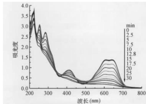
图2 在  $\text{Ce}^{3+}/\text{UV}$  下,AG 降解时的吸收光谱
