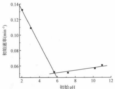
图 6 pH 对 AG 脱色初始速率的影响
