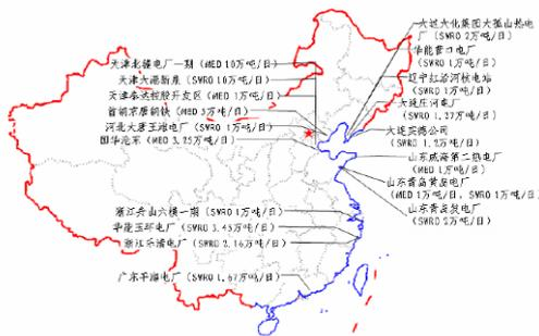
图 20 我国万吨级海水淡化工程分布
