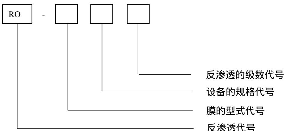
4.2.2 反渗透膜的型式代号(用汉语拼音字头表示)：
